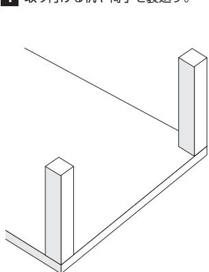
2 プラスドライバーを使用し、付属の取付ネジで取付穴の周囲を削りながらネジを留めて、家具に固定する。
