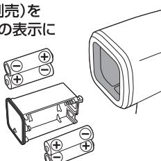
3 電池ボックスの矢印を下に向けて電池ボックスを元通りに取り付けます。
