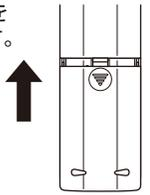
※電池カバーが外れない場合、本体を裏返して逆さに持ち、▼マーク(三角マーク)に親指をあて、押しながら上方向に電池カバーをスライドさせてください。
