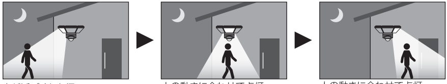
人が近づくと点灯 人の動きに合わせて点灯 (1灯目は点灯から約2秒後に消灯) 人の動きに合わせて点灯 (2灯目は点灯から約2秒後に消灯)
