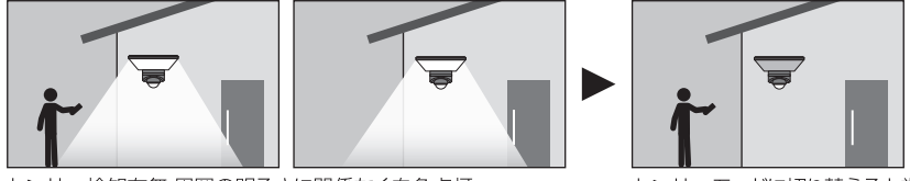
センサー検知有無・周囲の明るさに関係なく白色点灯 センサーモードに切り替えると常時点灯は解除
