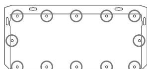
③さらに内部のネジ2本(図の○部分)を外し、白いカバーを持ち上げ
