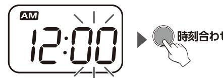
③もう一度設定ボタンを押すと時間の部分が点滅し、時間の設定になります。時刻合わせボタンを押すたびに1時間ずつ進みます。時刻合わせボタンを長押しすると速く進みます。
