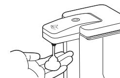
手洗いサポート機能 吐出後15秒間、LEDが点滅します。手洗い時間の目安に活用いただけます。
