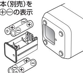
3 電池ボックスと本体底面の矢印の向きを合わせて、電池ボックスを元通りに取り付けます。
