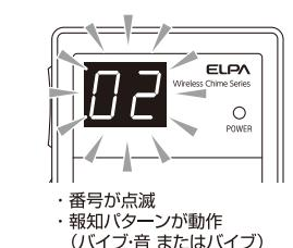
④リセットボタンを押す。または、10秒経過すると報知パターンが停止し、先に受信した履歴「01」が点灯表示されます。
