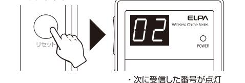
⑥再度リセットボタンを押すと次の履歴「02」がリセットされ表示が消えます。
