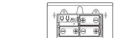
電池交換の際は、全て新しい電池に交換してください。
