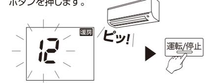
※通り過ぎた場合は、液晶画面の数字が点滅中に「温度設定」ボタンの下方向ボタンを押して戻すことができます。
