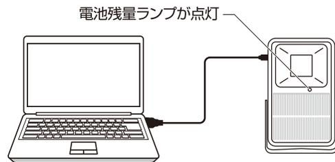
充電中は電池残量ランプが赤く点灯、充電完了時はランプが緑に点灯します。
