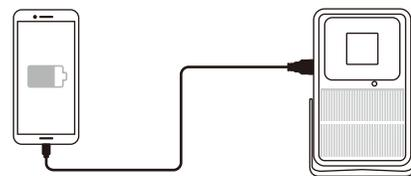
充電する時は各機器の充電に対応したUSBケーブルを本体のUSB差込口に接続します。
