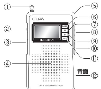
①FMロッドアンテナ ②音量ダイヤル ③イヤホン端子 ④スピーカー
