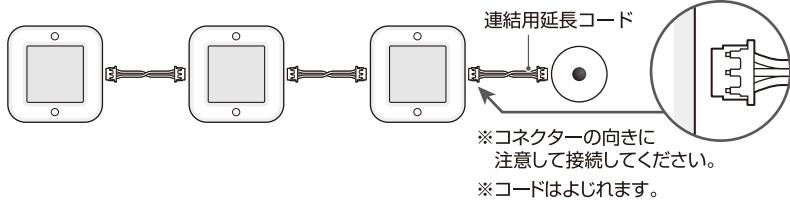
②本体と非接触スイッチを取り付けたい位置に合わせて、本体はネジ止め、または両面テープ、非接触スイッチは両面テープで取り付けます。
