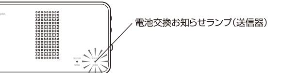
・複数の送信器を使用している場合、送信器の送信ランプを確認する事で電池交換が必要な送信器がわかります。
