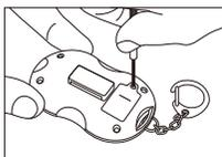
④カバーを取り付け、はずれないようにネジをしっかり締める
