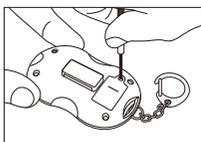
①本体裏面の電池カバーのネジをはずす
