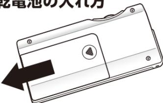
①本体裏側の電池カバーを図の方向にスライドさせて開けます。
